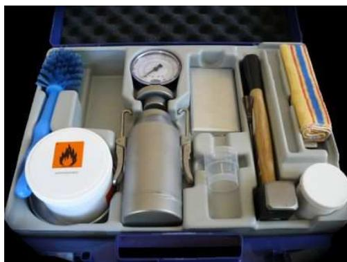
Figure 21 : Ustensiles requis par la méthode dite de la 'bombe à carbure'
