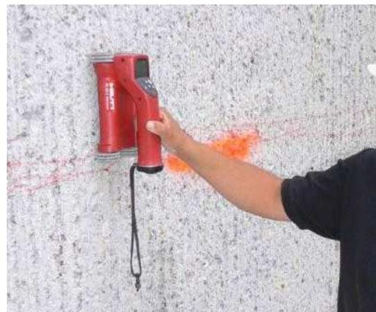
Figure 16 : Utilisation du 'Ferroscan'
