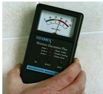
Exemple d'humidimètre de contact
