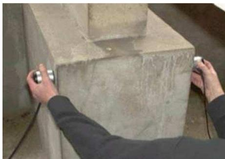
Figure 8 : Auscultation sonique appliquée à un bloc de béton.
